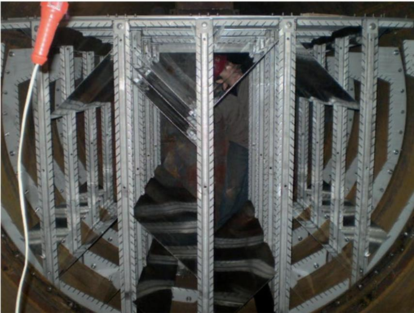
Fig. 2a: Sulzer Mellaplate W
