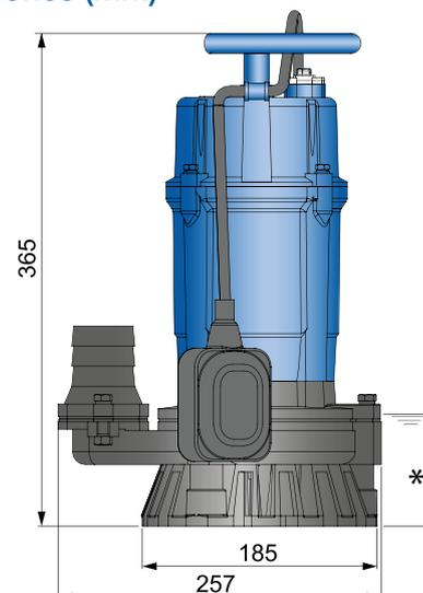
\* 85 mm lámina de agua funcionamiento continuo
