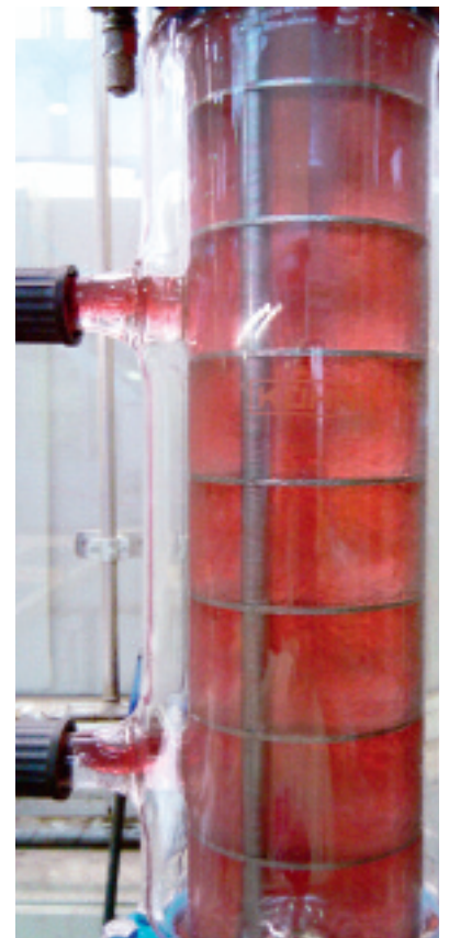
4 Pilotkolonne mit 60 mm Durchmesser.
