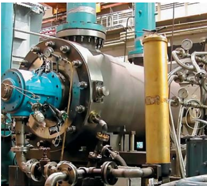
Параметрические испытания модернизированного насоса.
