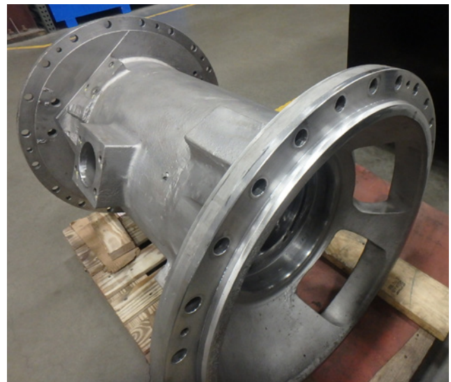
Se utilizó LMD para una restauración dimensional
