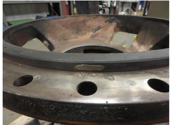
Ajustes axiales de la caja del compresor con picaduras de corrosión
