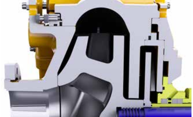
Ajuste de holgura mediante placa de aspiración regulable (a partir de tamaño 200).
