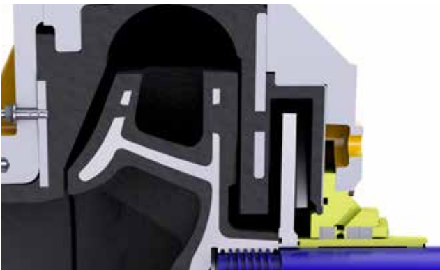
Placa de aspiración separada y desmontable (a partir de tamaño 200).
