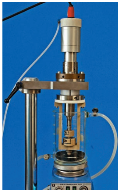
5 Beim Kavitationstest wird der Werkstoff in hochfrequente Ultraschallschwingungen versetzt.
