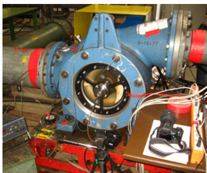
Испытание модели питательного насоса с направляющим аппаратом в уменьшенном масштабе
